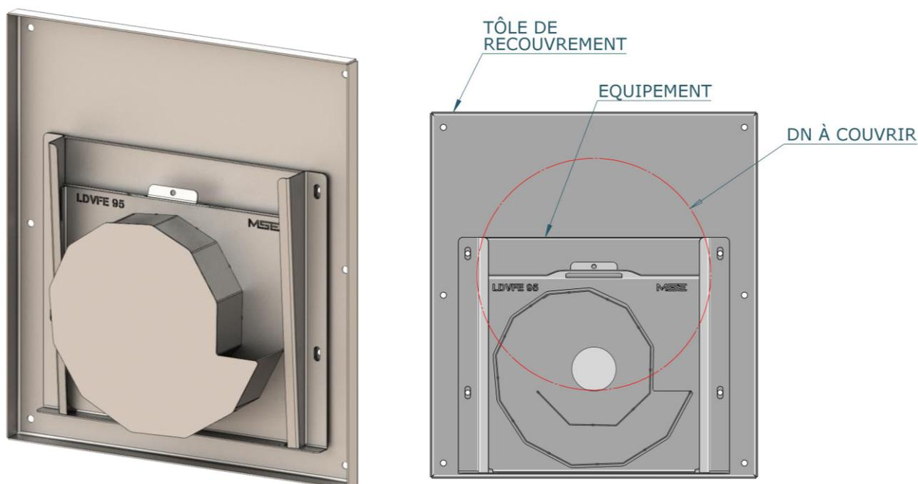
Exemple d'une tôle de recouvrement pour un limiteur de débit vortex LDVFE 95
