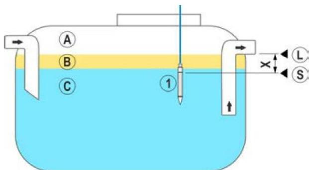
1 Sonde d'hydrocarbures idOil-OIL / idOil-OIL-S
