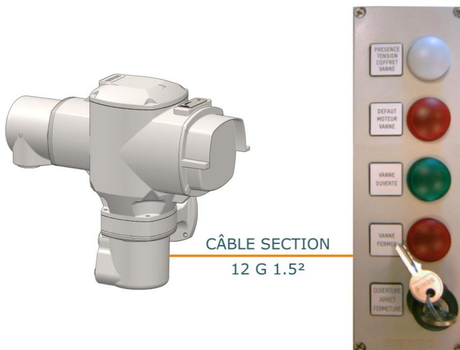
La fourniture du câble de commande déportée reste à la charge du client. Le nombre de brins est le minimum nécessaire. La section peut être augmentée jusqu'à 2,5 mm<sup>2</sup> au maximum. Sur ce type de configuration, l'alimentation de la commande déportée est réalisée en 24 V.
