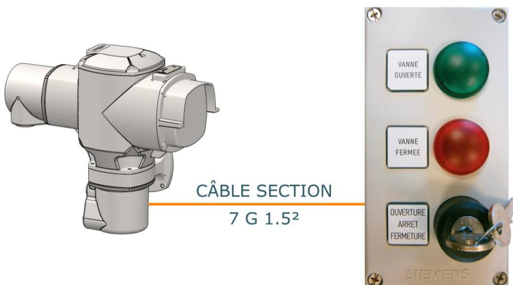
La fourniture du câble de commande déportée reste à la charge du client. Le nombre de brins est le minimum nécessaire. La section peut être augmentée jusqu'à 2,5 mm<sup>2</sup> au maximum. Sur ce type de configuration, l'alimentation de la commande déportée est réalisée en 24 V.
