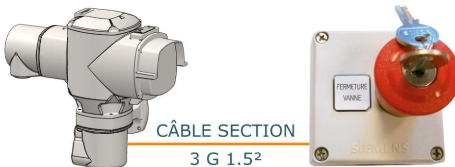
La fourniture du câble de commande déportée reste à la charge du client. Le nombre de brins est le minimum nécessaire. La section peut être augmentée jusqu'à 2,5 mm<sup>2</sup> au maximum. Sur ce type de configuration, l'alimentation de la commande déportée est réalisée en 24 V.
