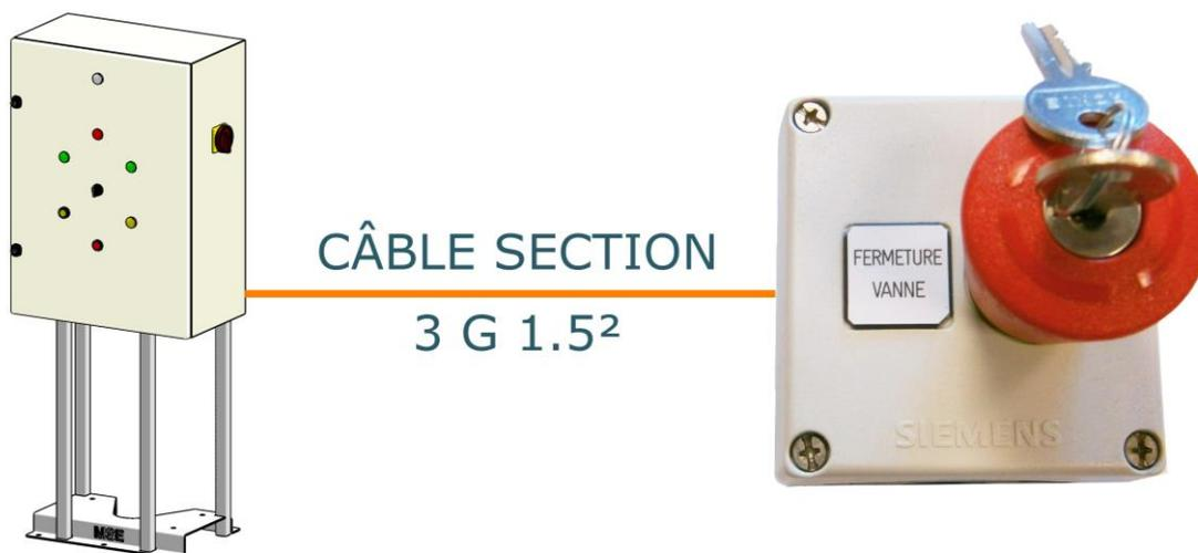
La fourniture du câble de commande déportée reste à la charge du client. Le nombre de brins est le minimum nécessaire. La section peut être augmentée jusqu'à 2,5 mm<sup>2</sup> au maximum. Sur ce type de configuration, l'alimentation de la commande déportée est réalisée en 220 V.
