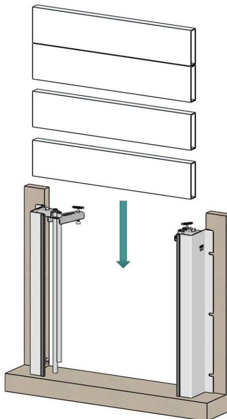
3. Enfiler les lames en veillant bien à positionner le joint entre chaque lame
