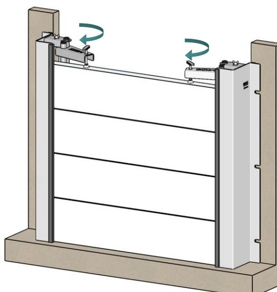
5. Serrer les vis de blocage comme indiqué ci-dessus pour bloquer les lames verticalement
