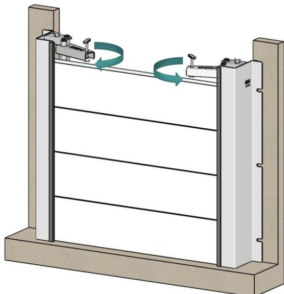
4. Tourner les coulisses gauche et droite comme indiqué ci-dessus pour bloquer l'ensemble des lames horizontalement (\*)
