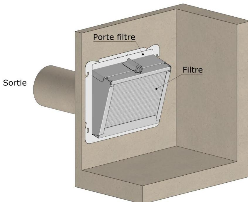
Afin d'assurer le bon fonctionnement du filtre, il est préconisé de laisser un volume de décantation sous le fil d'eau de 250 litres.
