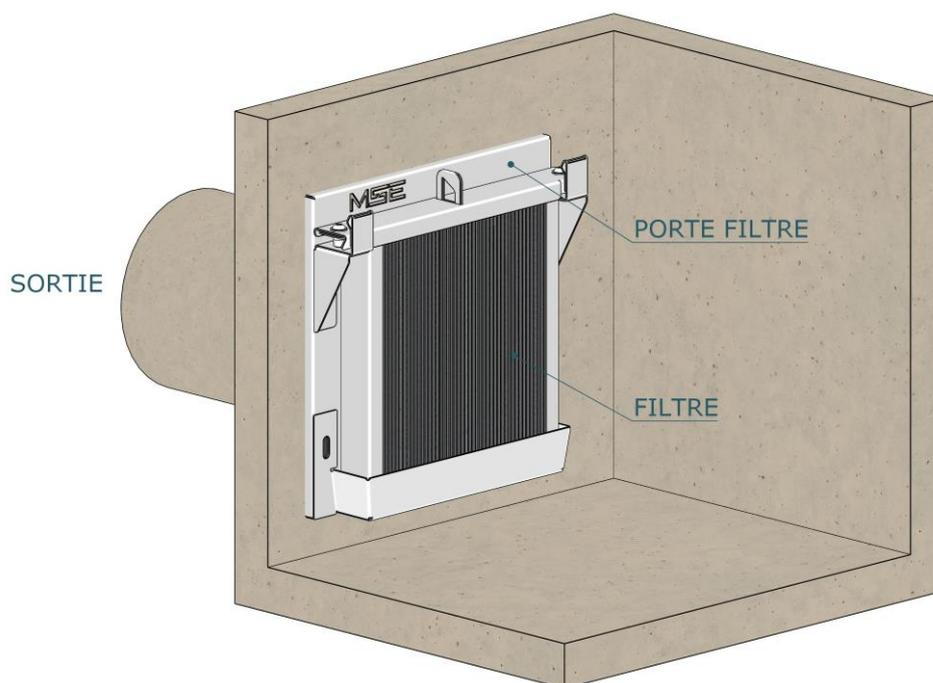
Afin d'assurer le bon fonctionnement du filtre, il est préconisé de laisser un volume de décantation sous le fil d'eau de 250 litres.
