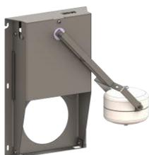
Le régulateur radial, conçu en acier inoxydable 304L est muni de glissières en PE et d'un flotteur accompagnant en fil d'eau la hauteur d'eau et entraînant la fermeture ou l'ouverture de la section de passage, régulant ainsi le débit.
