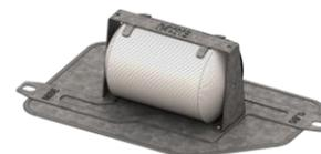
La cartouche filtrante est destinée à diminuer la teneur en hydrocarbures flottants de densité 0,85. Elle permet d'obtenir un rejet de 1 mg/l sur les hydrocarbures libres et non émulsionnés dans les conditions d'essais de la norme NF EN 858-1.
